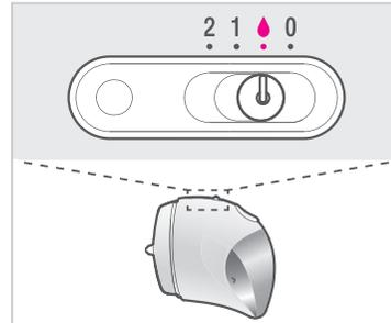
Si aucun liquide ne s'écoule ou si l'appareil a des difficultés à vaporiser le voile, suivre les instructions de la section « Utiliser la tige pour embout » (p. 65).
